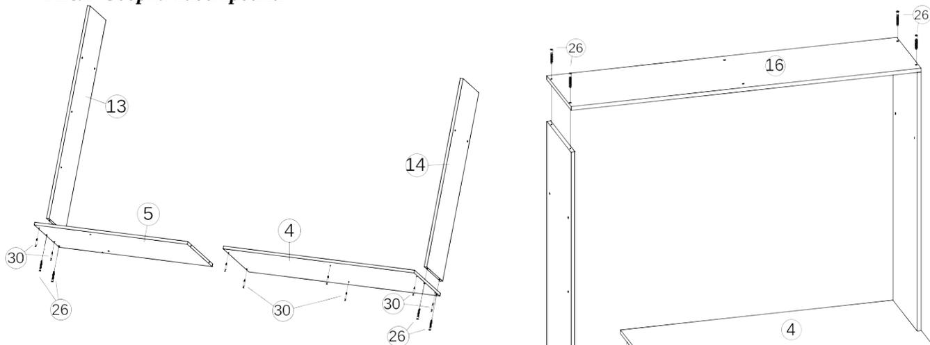
10. Установите Крышку (5) на Боковину тумбы(1) и соедините ее с Перегородкой(3) при помощи евроинтов (26). Затяните эксцентрики(29) по часовой стрелке до упора (см рис.3 и 6).
